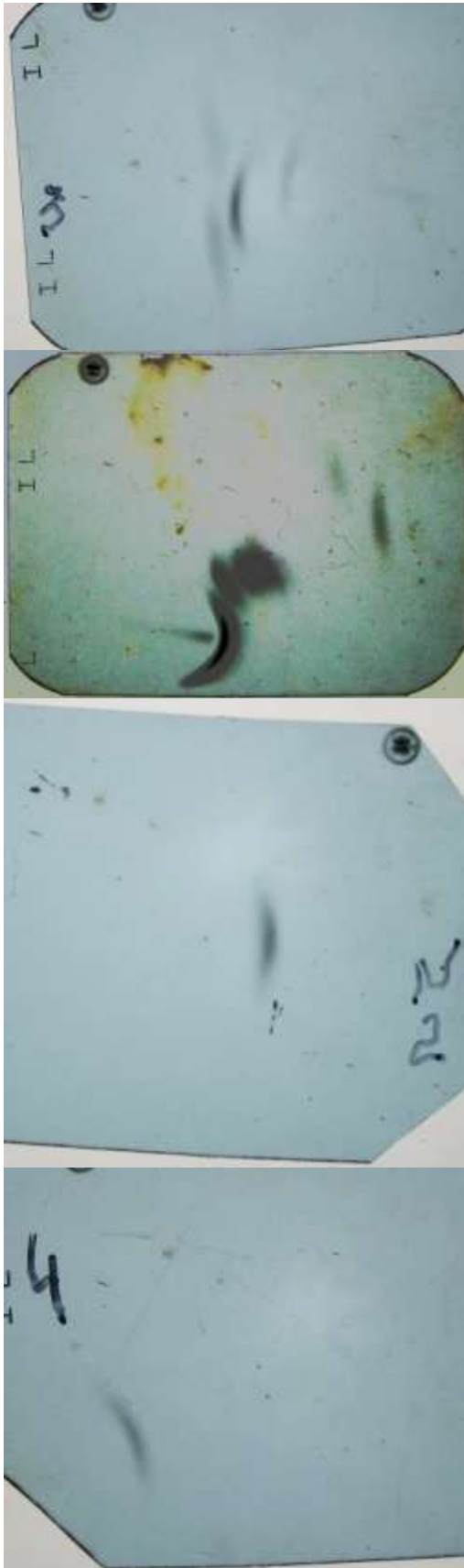
Фотографии 3-6. Фото на рентгеновской пленке зарегистрированного излучения, исходящего из кавитационной области.
