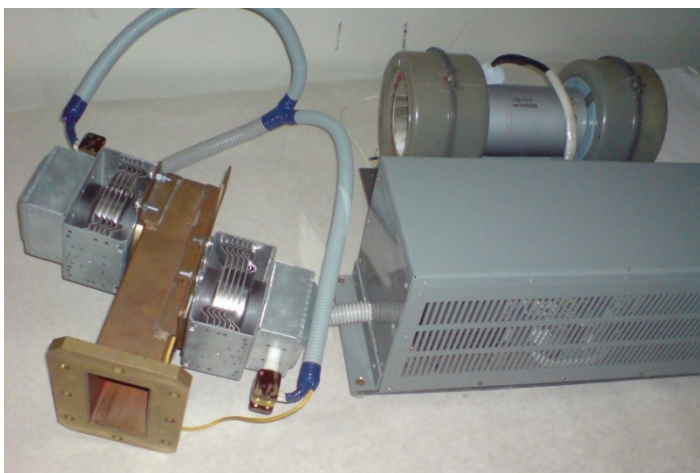
Фото 2. Генератор СВЧ на 2-х магнетронах
